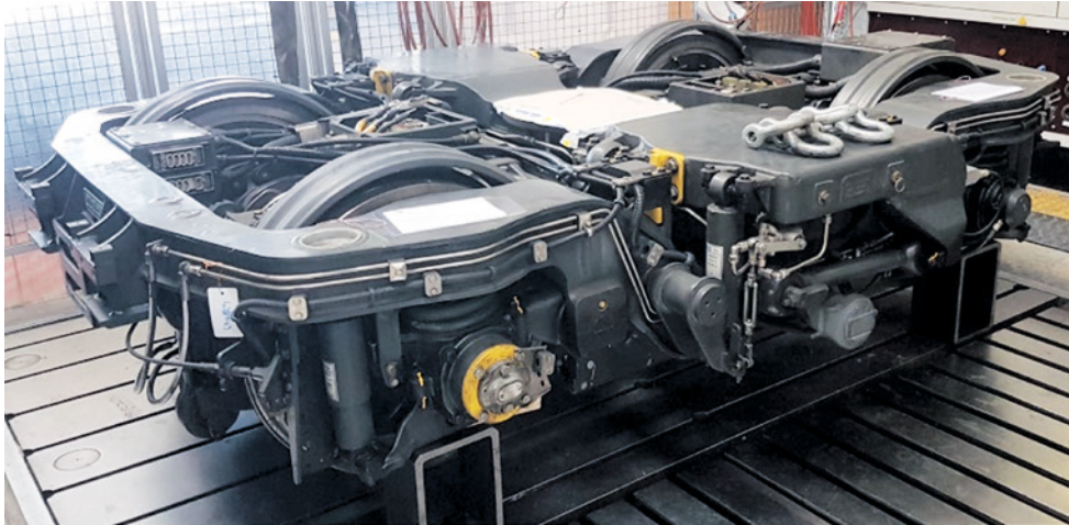
Untersuchung der Motorgetriebeeinheiten in eingebautem Zustand
